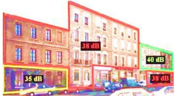
Le renforcement de l'isolement acoustique d'une façade peut être une exigence réglementaire au regard du classement sonore des voies lorsqu'un nouveau bâtiment se construit à l'intérieur du périmètre de nuisance d'une voie classée ou une mesure de résorption dans le cadre du traitement des Points Noirs Bruits destinée à améliorer le confort acoustique en garantissant à l'intérieur des bâtiments un ressenti moindre des bruits extérieurs issus des transports terrestres.
