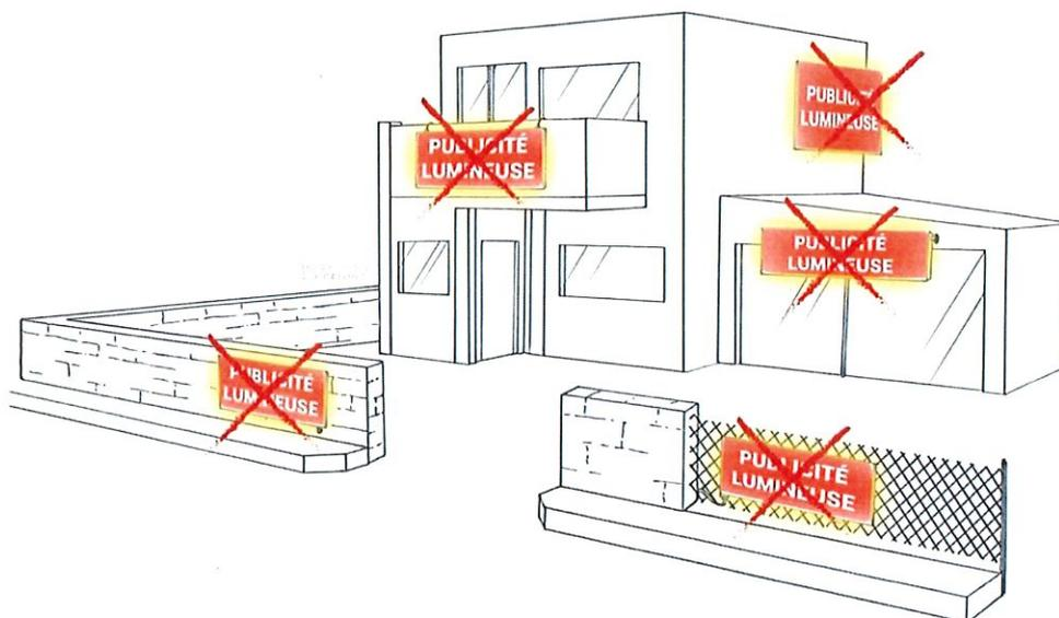
Lorsqu'une publicité lumineuse est située sur une toiture ou une terrasse en tenant lieu, elle ne peut être réalisée qu'au moyen de lettres ou signes découpés dissimulant leur fixation sur le support et sans panneaux de fond autres que ceux qui sont strictement nécessaires à la dissimulation des supports de base, sur une toiture ou une terrasse. Dans tous les cas, la hauteur de ces panneaux ne peut excéder 50 cm.
