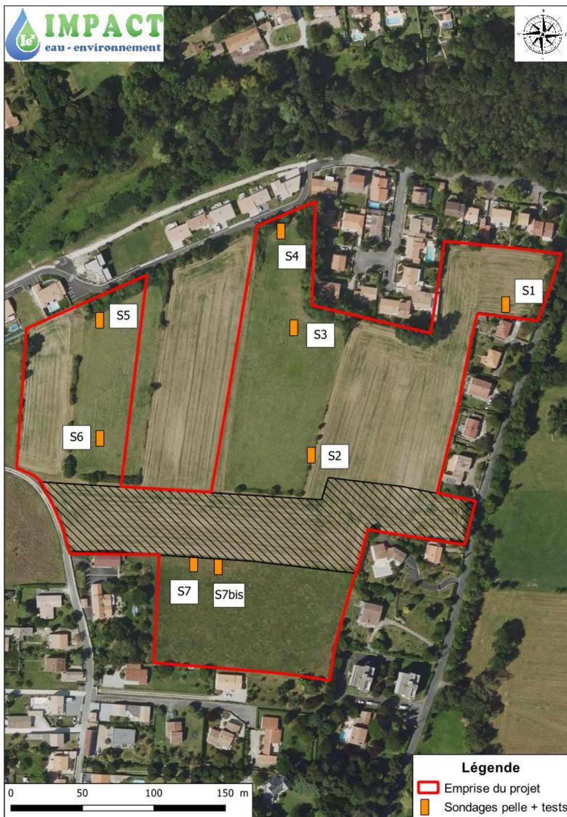
Figure 7. Localisation des essais de perméabilité
